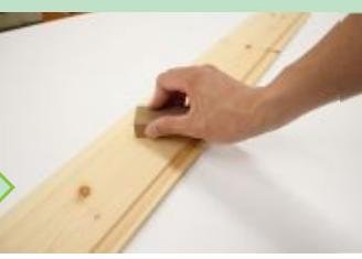
必要に応じて、サンドペーパー#240以上で研磨し、平滑な面に仕上げてください。
