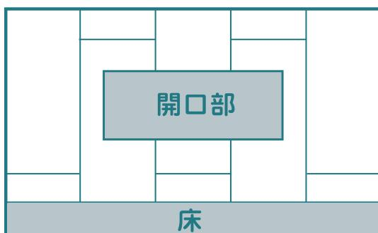
・ジョイント部分が窓、ドアの延長線にあると、開閉の際の振動等でクラックが入りやすい。
